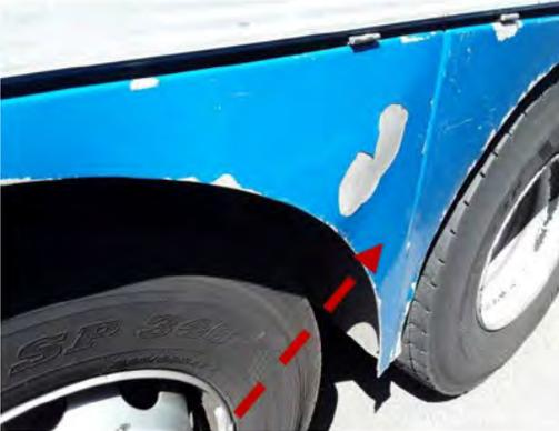
Aile de roue côté droit fissurée
