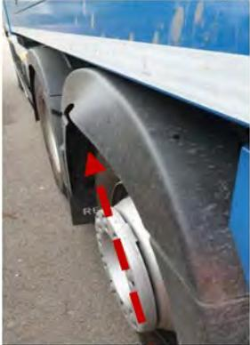
Ailes de roues déformées
