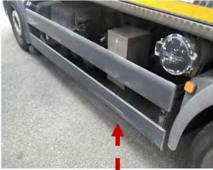
Exemple de barre anti-encastrement inférieure en bon état même si présence de quelques rayures
