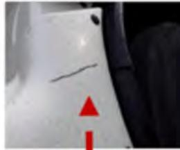
Aile de roue fissurée
