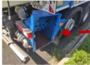
Exemples de coffres et rangements présentant des déformations et ou des éléments manquants
