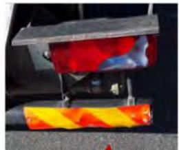
Todos los elementos de iluminación y señalización deben ser funcionales y reemplazados cuando estén dañados.
