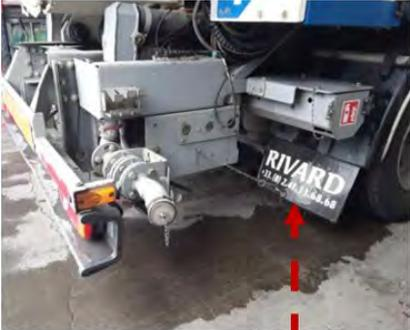
Exemple d'une bavette d'aile de roue 3ème essieu droit en bon état
