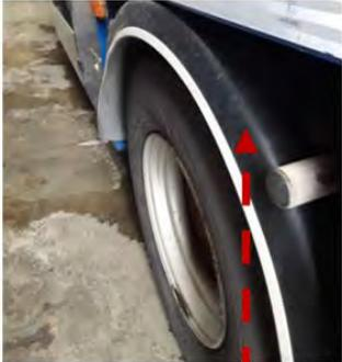
Exemple d'une aile de roue côté gauche en bon état
